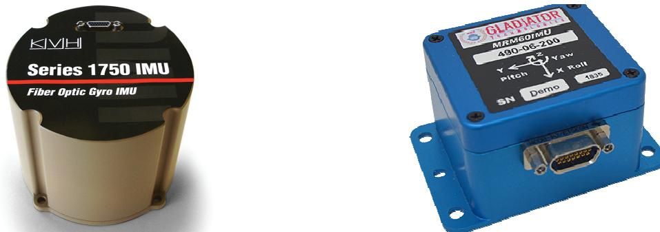
شکل (۱۰-۱) سمت راست: تصویری از یک IMU با فناوری MEMS<sup>۱۱</sup> با شش عدد فروجی در سه کانال خطی و سه کانال زاویه‌ای؛ سمت چپ: تصویری از یک IMU با فناوری «فیبر نوری» با شش عدد فروجی در سه کانال خطی و سه کانال زاویه‌ای.
