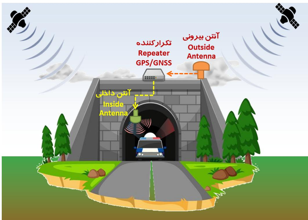
**شکل (۱۴-۳۸)** شماتیکی از نموده کارکرد یک تجهیز تکرار کننده سیگنال GPS/GNSS برای رفع مشکل عدم دریافت سیگنال‌ها در فضاهای مخصوص و بسته نظری داخل ساختمان‌ها یا در داخل تونل‌ها که امواج ماهواره‌ای به صورت مستقیم قابلیت دریافت ندارند؛ همانطور که در این شکل مشاهده می‌شود، با استفاده از یک تکرار کننده، سیگنال‌های GPS/GNSS، با یک نزد بالا و به صورت همزمان، از آتن (گیرنده) بیرونی تکرار کننده دریافت شده و توسط آتن (فرستنده) داخلی مخصوص برای گیرنده‌های موجود در آن فضای مخصوص، ارسال می‌گاهد شد.
