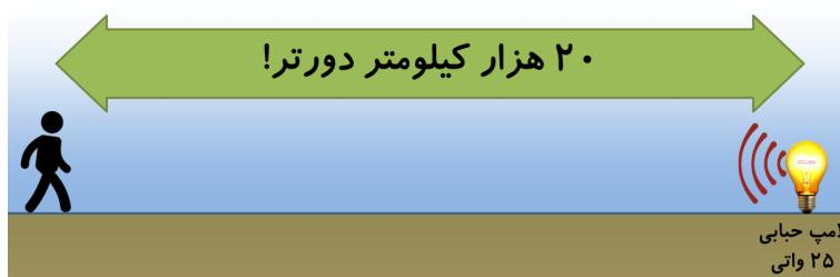
شکل (۲-۱۲) سطح توان سیگنال GPS دریافتی بر روی سطح زمین، با اندازه  $1.6 \times 10^{-16}$  وات، آنقدر ضعیف است که گویا یک لامپ حبابی ۲۵ واتی از فاصله ۱۲۵۰۰ مایل (قریباً ۲۰ کیلومتر دورتر) روشن شده و انتظار دریافت توان گرمایش آن را داشته باشید.
