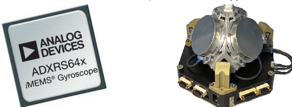
شکل (۱۲-۱) سمت راست: شماتیکی از یک جایروی نرخی با فناوری فیبر نوری و با گاربرد فضایی و با فطاوی دریفت (شناوری) بسیار اندک و در مرتبه  $1 \text{ Arcsec/hr}$ ؛ سمت چپ: شماتیکی از یک جایروی نرخی با فناوری MEMS.
