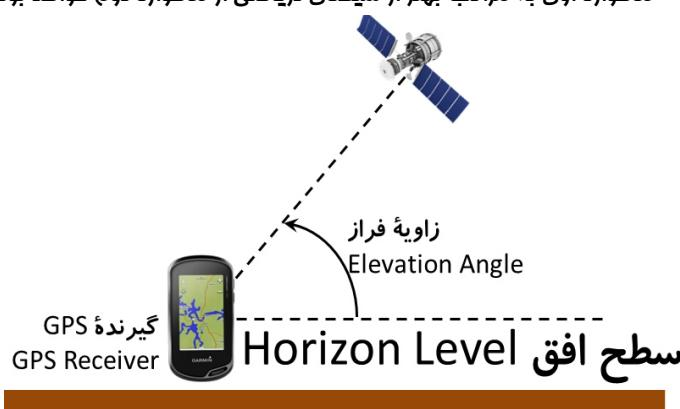
شکل (۱۴-۱۲) شماتیکی از زاویه فراز یک ماهواره GPS نسبت به گیرنده GPS
