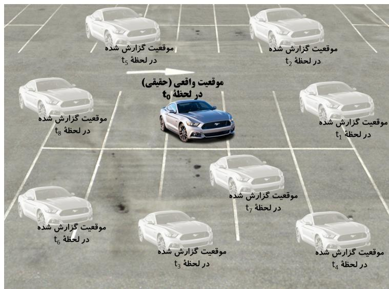
شکل (۱۶-۲۶) تصویری از آنچه که در عمل و با استفاده از داده‌های خروجی گزارش شده توسط یک گیرنده ثابت GPS در طول زمان (خ) می‌دهد.
