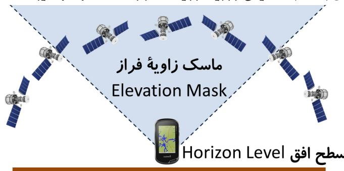
شکل (۱۴-۱۳) برفی گیرنده‌های GPS از یک فیلتر ماسک زاویه فراز مهتم امتناب از دریافت سیگنال‌های ماهواره‌هایی که پایینتر از یک زاویه فراز حداقلی هستند، استفاده می‌کنند.
