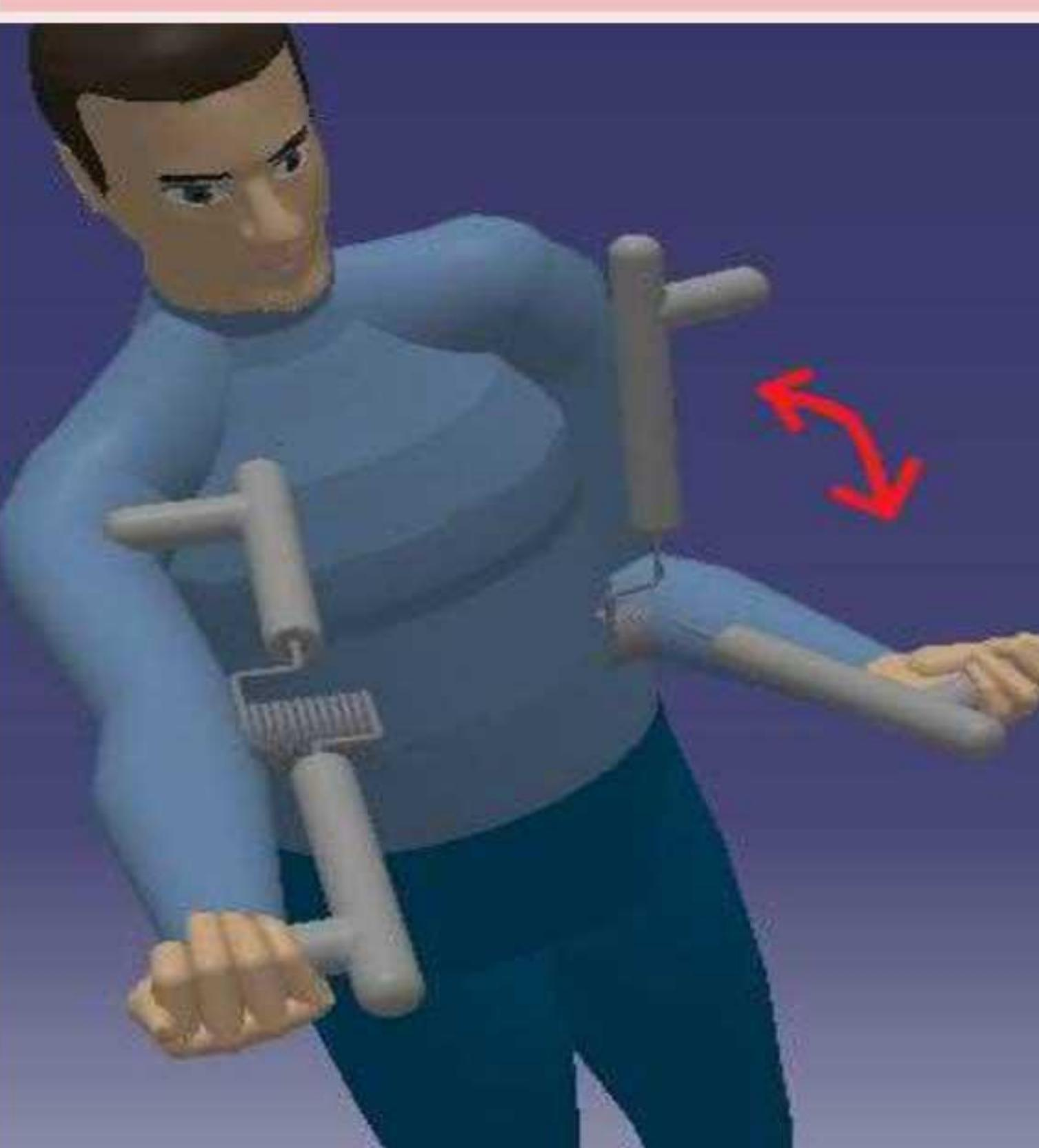
در این اختصار با استفاده از فنر های هلیکس که از دو طرف به دو دسته باتون شکل وصل شده اند یک دمبل مکانیکی طراحی شده است که از اوزان ۱۰۰ کیلو گرم تا ۱۰۰ کیلو گرم قادر به اعمال نیرو است و مکانیزم آن اصلاً ربطی به نیروی جاذبه ندارد. چرا که نحوه محاسبه نیروی آن بر اساس کیلو گرم نیز نمی‌باشد و بر اساس گشتاور نیوتونی، توان یک فنر مورد محاسبه قرار می‌گیرد. از آنجا که یک کیلو گرم برابر با ۱۰ نیوتون می‌باشد. این فنر ها بر اساس همان نیروی اعمالی دمبل ها استاندارد شده اند. همانند دمبل های
