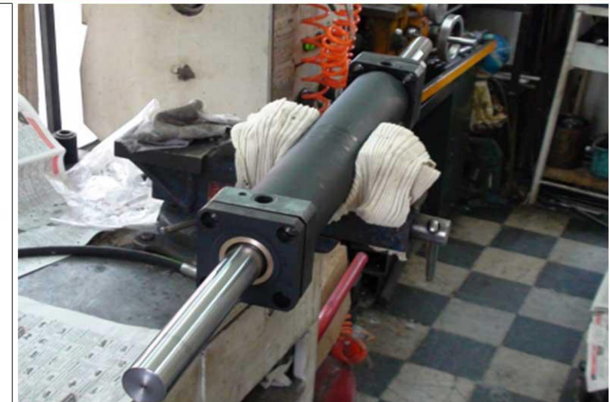
میراگرهای ویسکوز در عنوان جاذب انرژی در سازه عمل کرده و بخشی از انرژی لرزه ای وارد شده بر سازه را مستهلك می کنند. مشکل فعلی در استفاده از میراگرهای ویسکوز در کشور قیمت بالای این محصول می باشد که عدمه دلیل آن عدم تولید میراگرهای ویسکوز در داخل کشور است.
