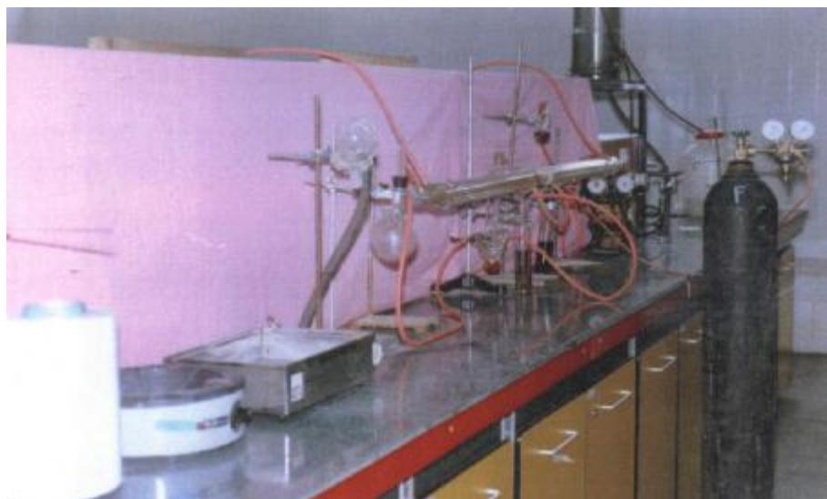
شکل-۲- نمای کلی از دستگاه روکش دهی الیاف به روش تبخیر مداوم
