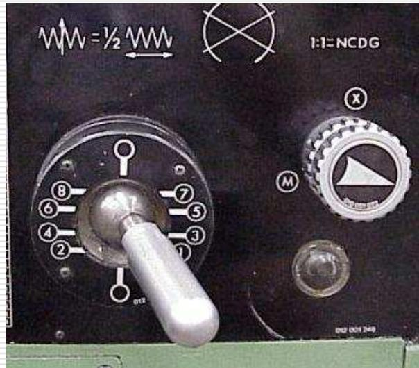
صفحه مخروطی تغییر سرعت محور اصلی روی جعبه دنده سرعت قرار گرفته است، که با چرخاندن آن بوسیله دست هریک از دورهای لازم را که قبل از تعیین شده می‌توان بدست آورد. سرعت ماشین بر حسب اندازه و نوع قطعه کار و نوع دنده تراشی که بکار برده می‌شود تعیین می‌گردد. بطور کلی سرعت ماشین بعد از اینکه قطعه کار و دنده تراش روی ماشین قرار گرفته تنظیم و ضمناً سرعت ماشین بر حسب دور در دقیقه منظور می‌گردد.
