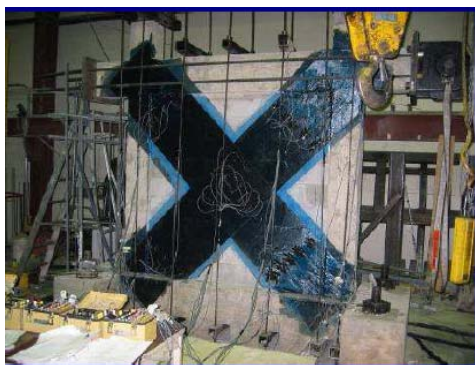
شکل - ۳۵ دیوار آجری تقویت شده با FRP
