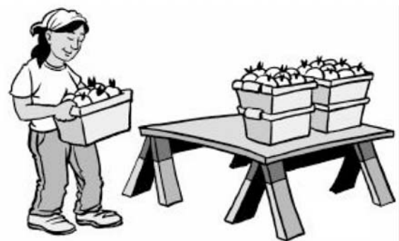
طراحی خوب برای ظروف حمل : دسته دارد و جسم به بدن نزدیکتر است.
