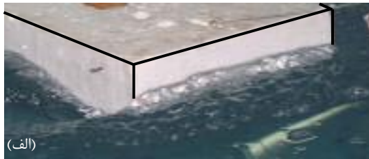
شکل ۱۸- تغییر شکل سطح آزاد در جلوی شناور بارج (الف): کار تجربی، (ب): شبیه سازی عددی
