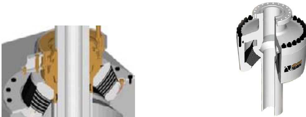
شکل (۲): برش از اتصال انعطاف پذیر دارای لایه های فولاد و الاستومر شکل (۳): اتصال فوقانی تاندون
