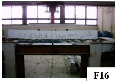
شکل ۷ - نحوه آزمایش وترک خوردگی تیرهای F8، F16، F12 و 2F14
