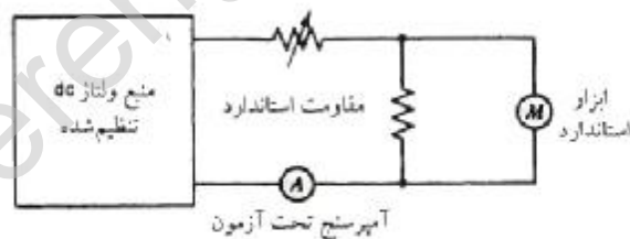
شکل ۲۶، ۲ مدار کالیبره کردن یک آمپرسنج dc.
