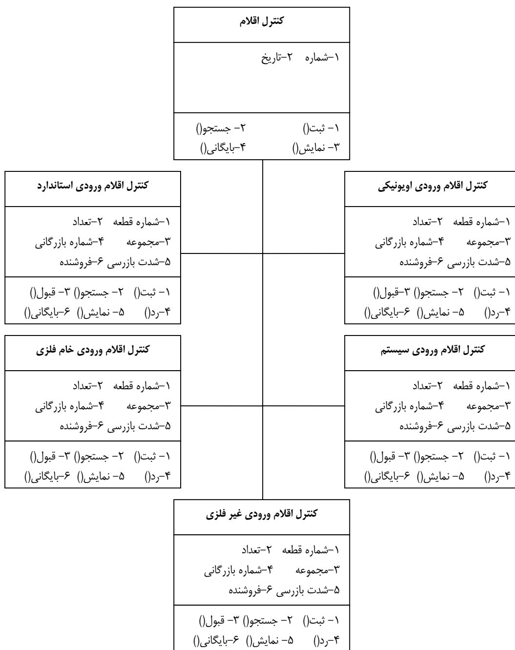
شکل ۳: دیاگرام سطح دوم اشیاء کنترل اقلام سیستم کنترل کیفیت در صنایع هوایی
