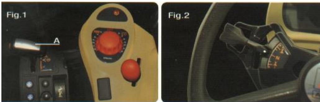
شده است . با این امکان اضافه شده در اهرم چپ غربالک ، متوجه شدید که این اهرم ، تنها جهت کنترل حرکت جلو و عقب نیست بلکه برای تعویض اتوماتیک دنده ها نیز استفاده می شود. سیستم کنترل الکترونیکی همچنین قادر به تنظیم درگیری کلاچ \_ برای تعویض ملایمتر \_ میباشد که با این امتیاز در واقع علاوه بر روانی تراکتور ، بارهای مازاد وارده بر وسیله وصل شده به تراکتور تا حد بسیار زیاد کاهش خواهد یافت.
