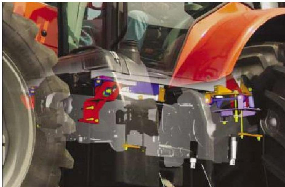
البته این تراکتورها از یک سیستم تعلیق هیدرولیکی نیز بهره میگیرند (HydraMaxx) که با تداوم بخشیدن به تماس چرخها با خاک و در نتیجه کاهش اتلاف انرژی حاصل از لغزش ، راندمان کار را افزایش میدهد.
