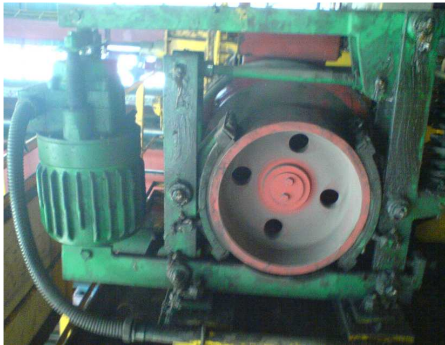
شکل ۷- نمونه ای از یک ترمز الکتروهیدرولیکی
