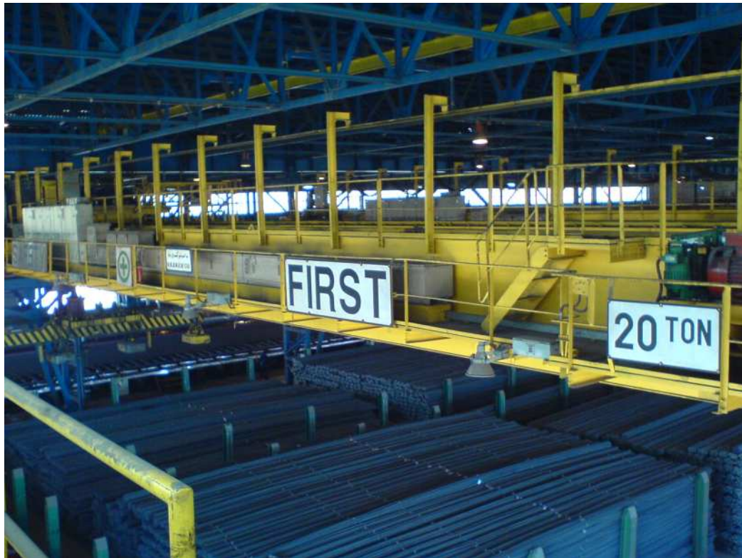
شکل ۵- جرثقیل سقفی دارای مگنت جهت حمل محصول و بارگی
