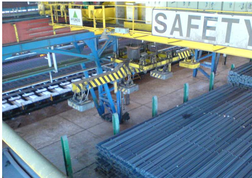
شکل ۴- نمونه ای مگنت های غیر دائم در واحد جرثقیل
