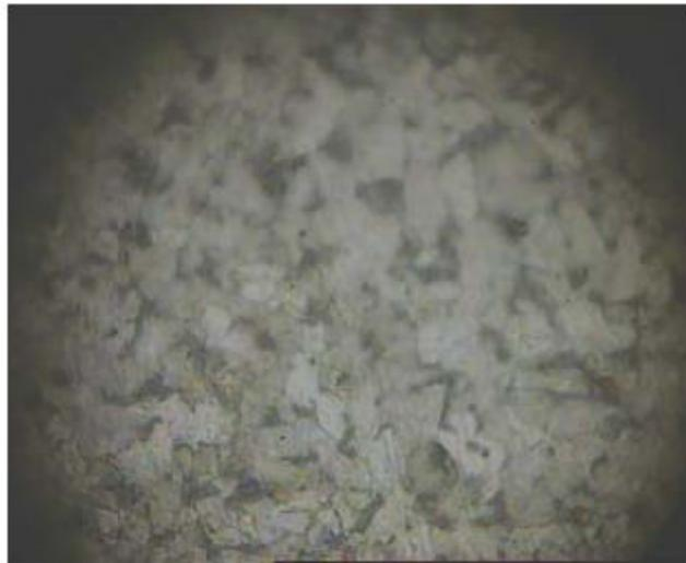
**نمونه شاهد B** : حاوی فاز پرلیت ( تیره ) و فریت ( روشن ) می باشد. بر روی نمونه عملیات حرارتی صورت نگرفته است.
