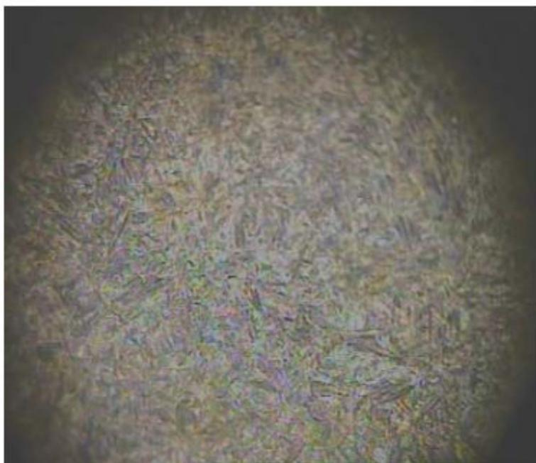
**نمونه شاهد G** (۹۵۰ درجه سانتیگراد و ۱۵ دقیقه) : با سختی متفاوت مارتنزیت شده است . چرا که دانه های آستنیت درشت تر شده اند و قابلیت سخت شدن افزایش یافته است . دانه ها و سوزن های مارتنزیتی نیز بزرگتر و بلند تر شده اند . دیگر خواص مکانیک کاهش یافته اند و با اینکه سختی افزایش یافته ، ازین روش برای بالا بردن سختی پذیری استفاده ای نمی شود .
