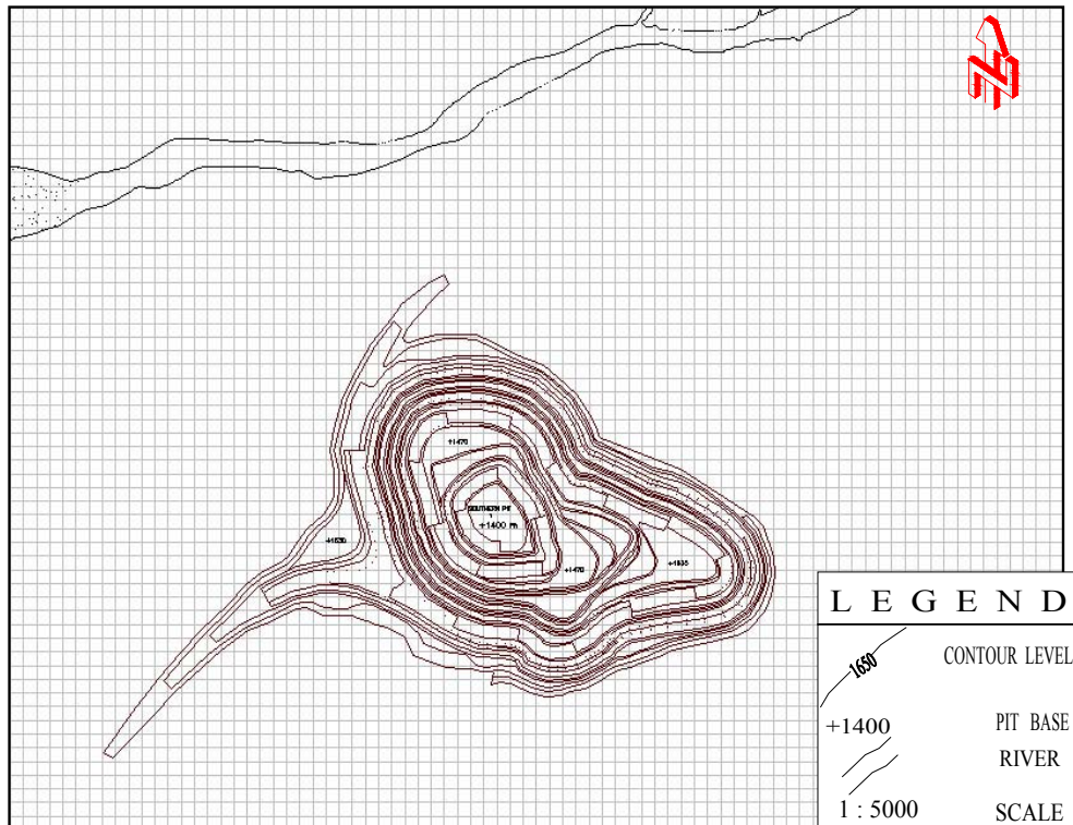
شکل 2: شبکه‌بندی محدوده‌ی معدن سه‌چاهون به کمک نرم‌افزار Modflow
