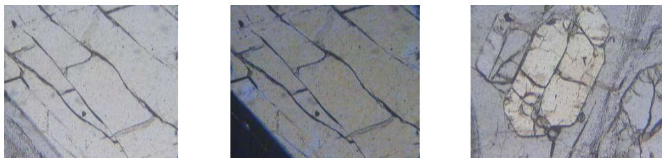
شکل ۲- بلور سانیدین در خمیره شیشه ای ، به ترکهای ناشی از سرد شدن سریع توجه شود.
