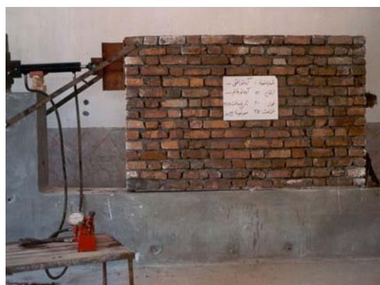
شکل ۹ آزمایش دیوار برشی آجری تحت بار جانبی
