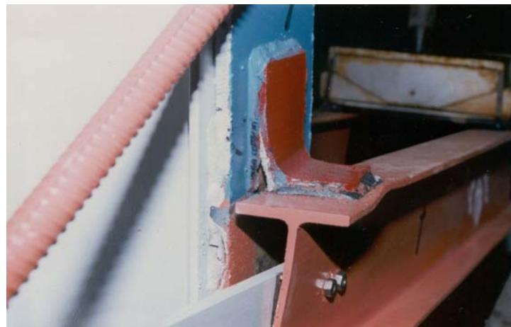
شکل ۱۸ نقطه آغازین گسیختگی جوش در اتصالات خرجنی (نقل از مقدم و کرمی (۱۴)).
