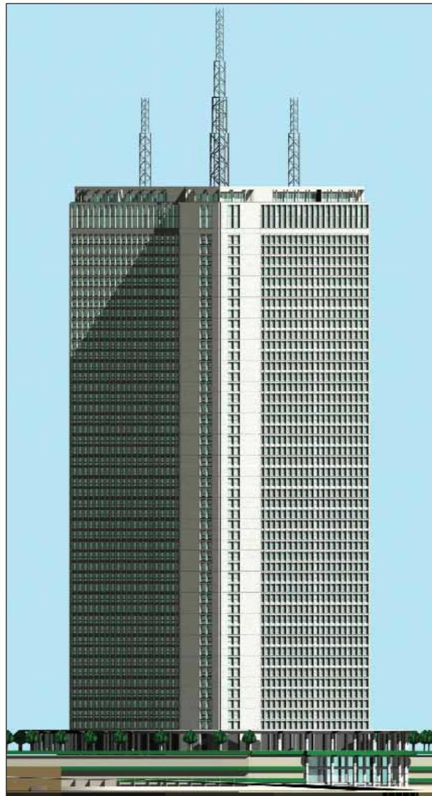
جداره به رنگ سیز رفلکس به ارتفاع ۲۲۰ cm، به پهنای ۱۶۸-۱۲۰ cm بازشویه ارتفاع ۱۴۰ cm در بخش فوقانی پنجره ها به دو شکل لو لاپی و محوری (Tilt turn)
