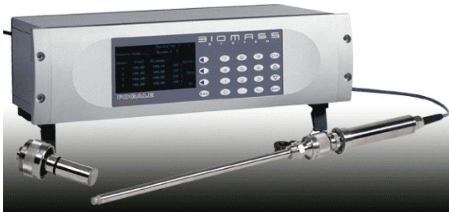
شکل ۴. دستگاه مورد استفاده در اندازه گیری کاپاسیتانس. FOGALE nanotech.
