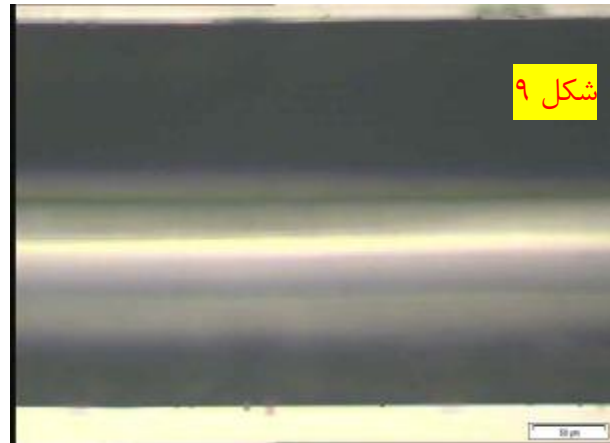
شکل ۹ - موی بز آماده سازی شده با پلی وینیل استات (چسب چوب) در دمای محیط
