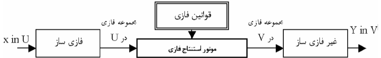
شکل ۲- ساختار اصلی سیستم های فازی با فازی ساز و غیر فازی ساز
