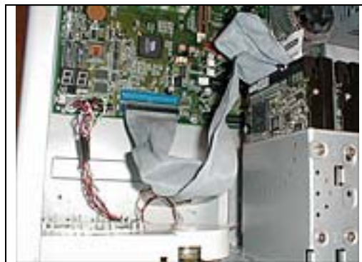
اتصال کابل های ریبون IDE هاردرایو
