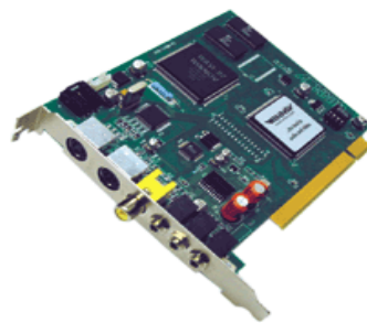
شکل ۱۲-۱. نمونه هایی از کارت های ویدیویی با ورودی و خروجی های مختلف
