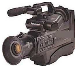
شکل ۴-۱. دوربین فیلم برداری آنالوگ VHS
