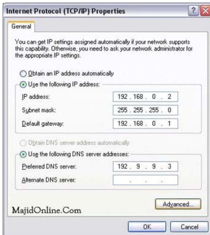
اکنون اتصال بین دو رایانه با یک کابل به صورت مستقیم برقرار است. برای اطمینان کار دو سیستم را یک بار ریست نمایید.
